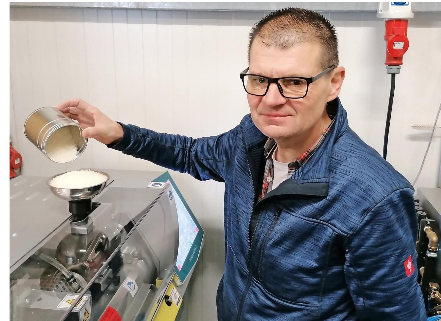
Jürgen Müller befüllt die Maschine, welche die Kaffeekapseln produziert. Der gesamte Apparat ist in Eigenregie entstanden.
